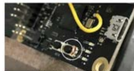
実作業（はんだ接合）
