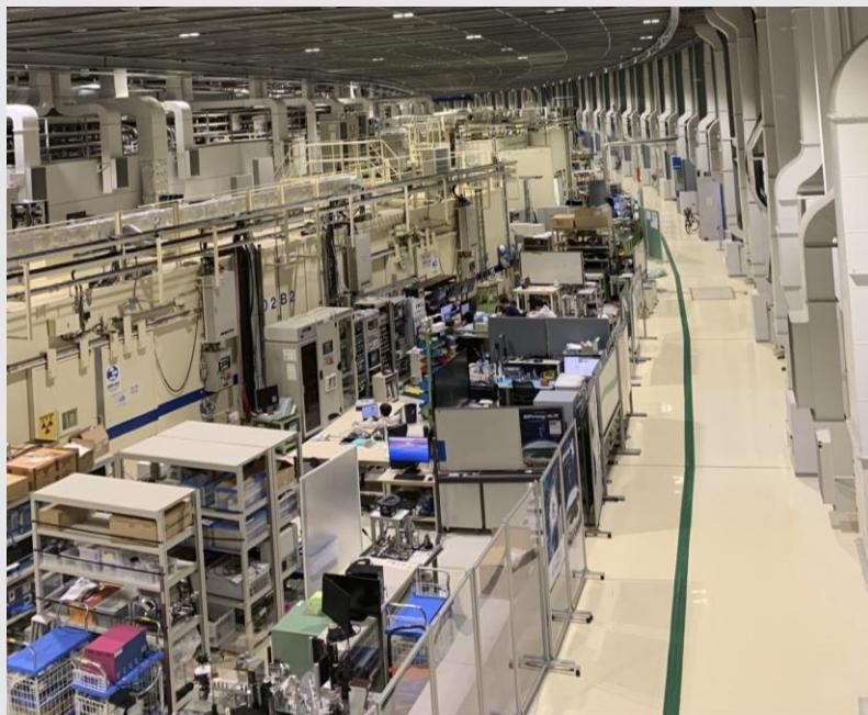
SPring-8には多様なX線分析技術を利用可能なビームラインと呼ばれる設備が整備されています。それらのうち、X線回折・散乱、X線イメージング技術、等を利用可能なビームラインを紹介させていただきます。
