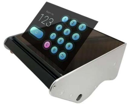
独自の技術により、明るく鮮明な空中結像を実現しています。タッチパネルに触れる事が無く画面操作が可能のため、衛生面でも安全です。
