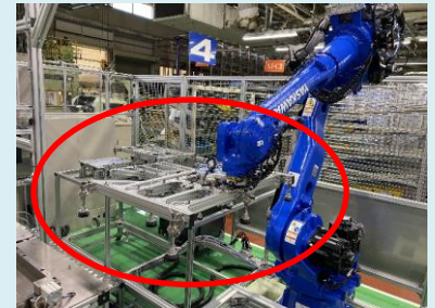
<③ツールチェンジャー> 対応機種ごとに自動で吸着ユニットを段替え。全機種搬送を実現。
