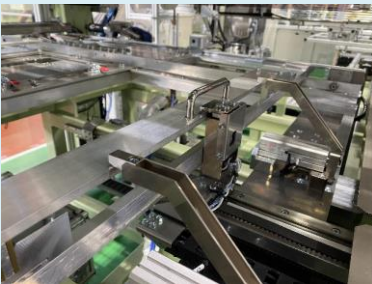
<①クランプ掴み替え> 設備のセットステージ側と加工ステージ側でクランプの掴み替えを行う。
