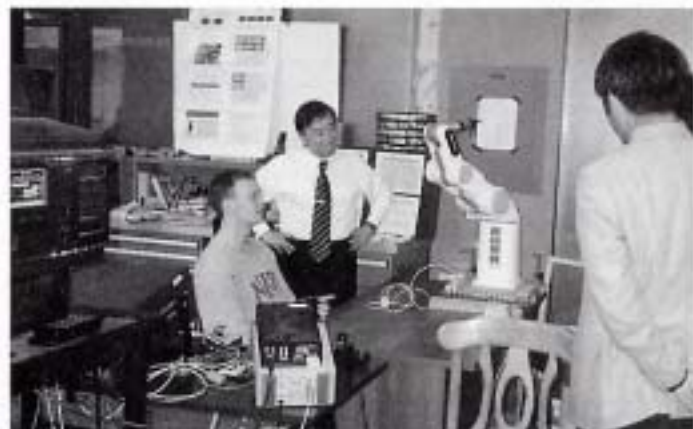
▲身体障害者の手元より送られる信号をロボットボディー中に付帯したセンサーが受信し、ロボットを遠隔操作できる。このシステムは、身体障害者就労のための人間とロボットが共存できるシステムである。
