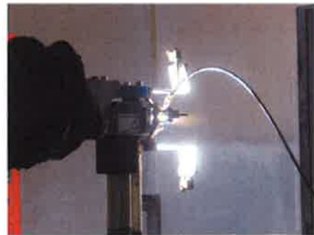
溶射装置の動作検証試験
