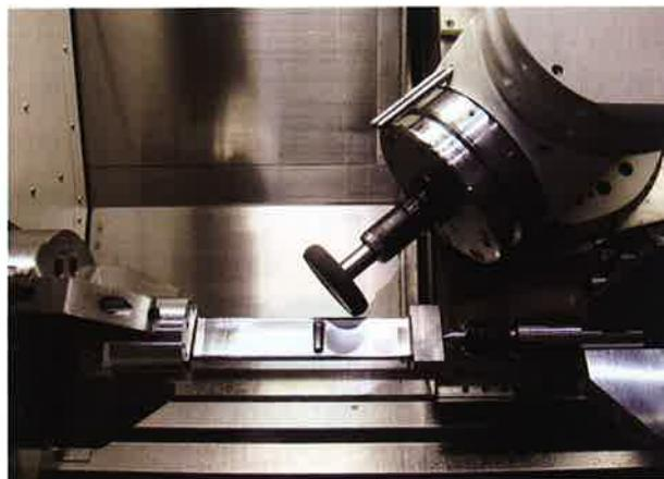
タービンブレード翼面研削加工
