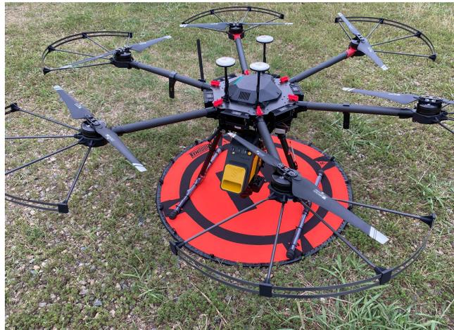
レーザ測量用ドローン
