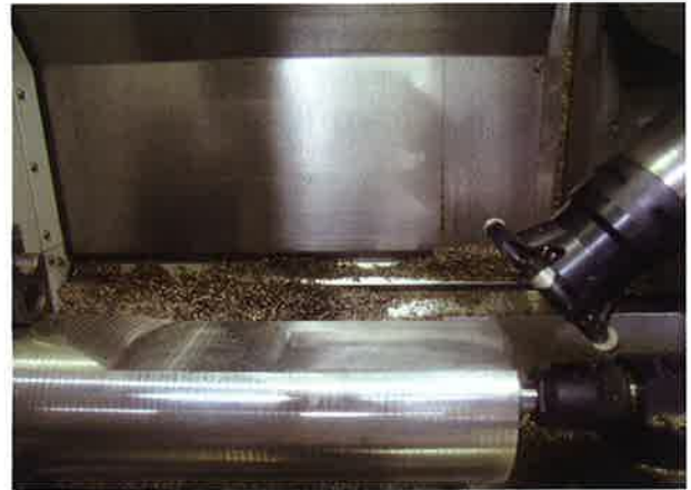
多刃カッターによる高能率加工
