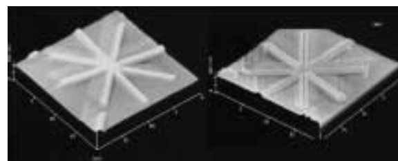
(写真)ガリウム・ヒ素基盤上に作製した凸型(左)凹型(右)の微細構造体
